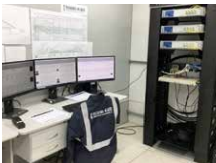
FIG. 9 – À ESQUERDA: SALA DE CONTROLE COM 3 INTERROGADORES BRAGGMETER INDUSTRIAIS. À DIREITA: EXEMPLO DE UM PAINEL COM VISUALIZAÇÃO DE DADOS EM TEMPO REAL SOBRE UM ALÇADO DA PONTE.
