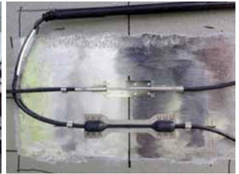
FIG. 8 – SENSORES ÓTICOS DE DEFORMAÇÃO (FS62) E DE TEMPERATURA (FS63). ACIMA À ESQUERDA: COMPÓSITOS. ACIMA À DIREITA: SOLDÁVEIS. À ESQUERDA: PROCESSO DE SOLDADURA.
